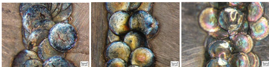
Figura 3.4.12- Aspectul stereomacrostructural în secțiune longitudinală a probelor sudate din aliajele experimentale de cobalt: a- aliaj CoCrMoTi 3,5 ; b- aliaj CoCrMoTi 4 ; c- aliaj CoCrMoTi 4,5
