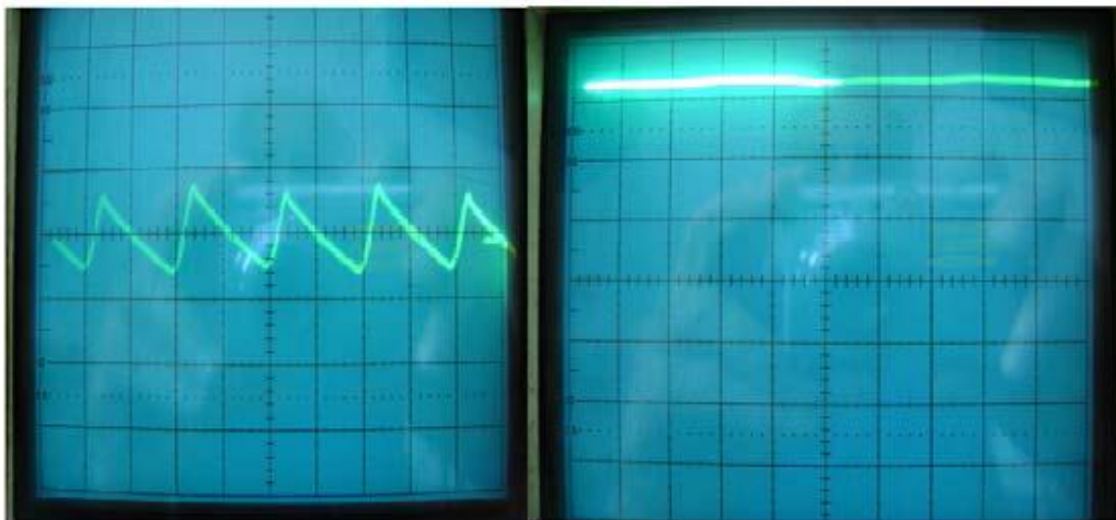
Fig. 3.4 Amplitudine mare/ mică a rippleului de curent
