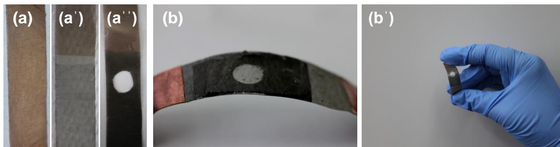
Figura 4.18. Imaginile fotografice ale electrozilor fabricați pe substraturi flexibile: (a) - fibrele de PMMA acoperite cu Au, (a') - fibrele aurite acoperite cu Ag/AgCl, (a'') - fibrele aurite acoperite cu Pd/PdO și ale (b, b') senzorului acoperit cu un film de hidrogel de PAAm.
