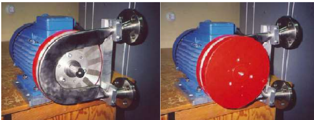
Figura 2. Pompa electromagnetă cu magneți permanenți. PSI, Elveția
