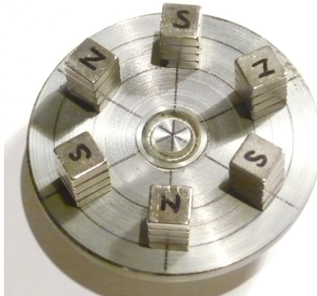
Figura 5. Poziționarea magneților permanenți în formatul cu șase magneți
