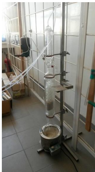
Figura 3.4. Instalația experimentală pentru eterificarea in situ a olefinelor din benzina de cracare catalitică
